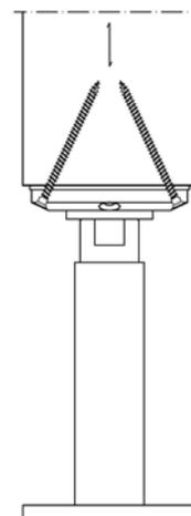
**Hinweis:** Zur leichteren Montage können Fußplatten mit Gewindestange und Schutzhülse abgeschraubt werden.
