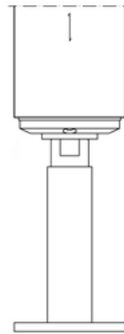
Nach der Zentrierung der Kopfplatte können die mitgelieferten 12 Vollgewindeschrauben in einem Winkel von 25 Grad ohne Vorbohren montiert werden.
