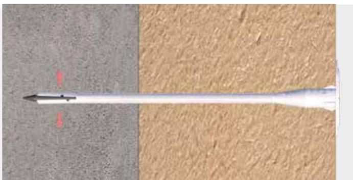
Durch den Nagel weitet sich der Klimax Dämmstoffdübel, sodass eine feste Verankerung im Untergrund entsteht.
